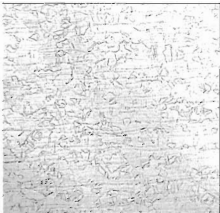
Fig. 11. Microestructura de una aleación de cuproníquel de composición 70Cu 30Ni, en estado sólido.
